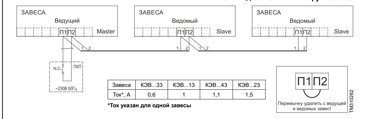
Схема подключения ПКП к группе завес
