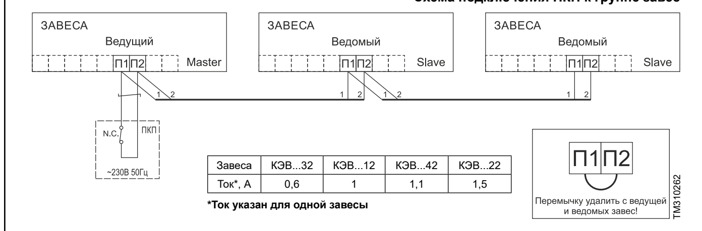
Схема подключения ПКП к группе завес
